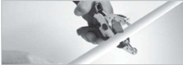
1. Rohr mit Rohrschere oder Rohrabschneider rechtwinklig ablängen.
