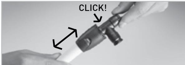
4. Adapter bis zum hörbaren Klick auf das Modul stecken und anschliessend auf Zug belasten.
